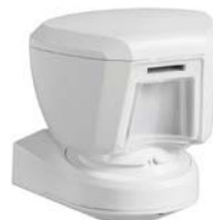
PG8994 Détecteur IRP 12m extérieur, hauteur de pose 3m, immunité 18kg Autonomie 3 ans
